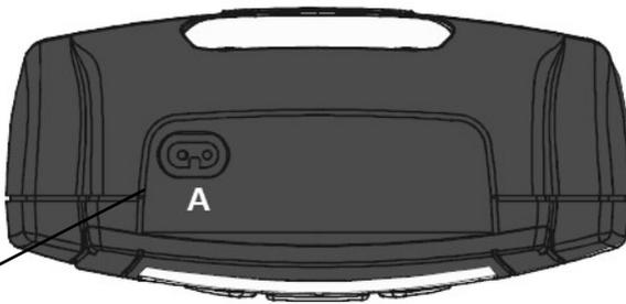
Steckplatz für das Elektrodenkabel
